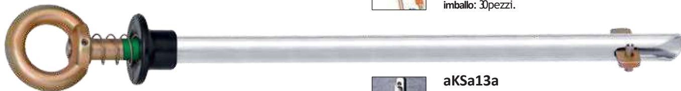
aKSa13 Punto ancoraGGio Per traVe d'acciaio riutilizzaBiLe en795:2012 Punto di ancoraggio passante per travi con spessore di circa 40mm. Il fissaggio deve essere fatto tramite un foro di diametro compreso tra 21 ed i 30mm. L'ancoraggio è fornito di indicatore verde che diventa visibile se l'ancoraggio è stato fatto in modo corretto. Resistente fino a 23KN. imballo: 30pezzi.
