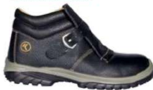
36140 EBRO EN ISO 20345 S3 SRC Calzatura alta apposta per saldatori in pelle fiore stampata, copri soletto (plastico e non laccio) gara scorie, chiusura con fibbia e sfilamento rapido. Cuciture in fibra aramidica che determinano una maggior resistenza delle scarpe ma soprattutto una protezione dalle scintille della saldatura. Suola in PU bidonata.
